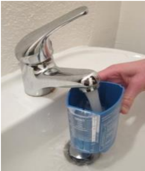
Mesures avec débitmètre
